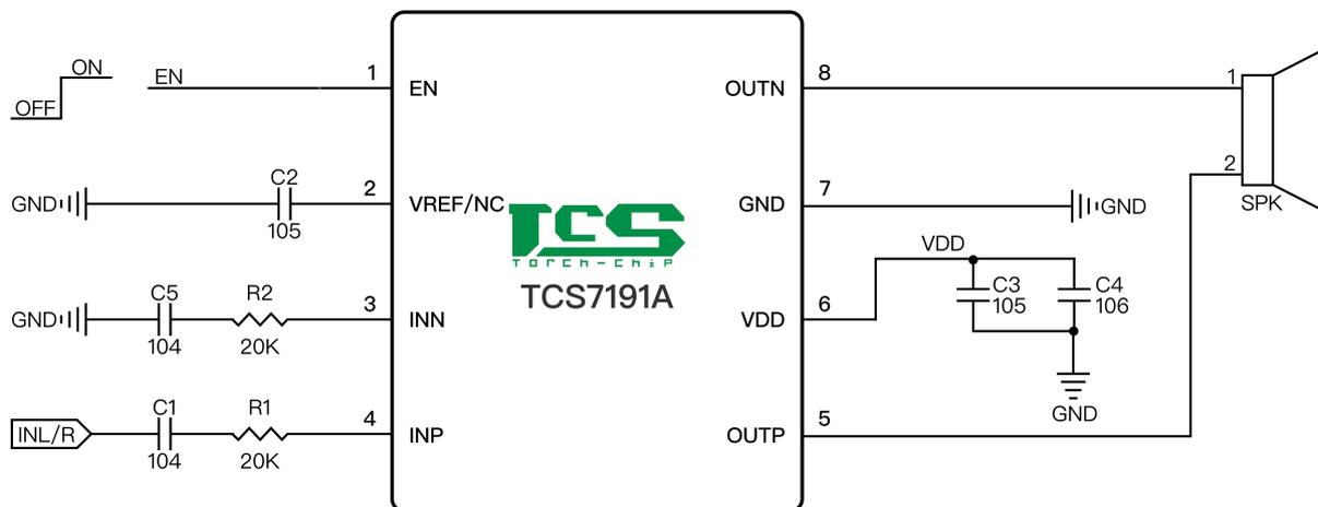
**注意：接差分信号第二PIN可以默认为NC无需接电容，接单端信号输入考虑噪声要保留此电容，建议预留此电容位置。**
